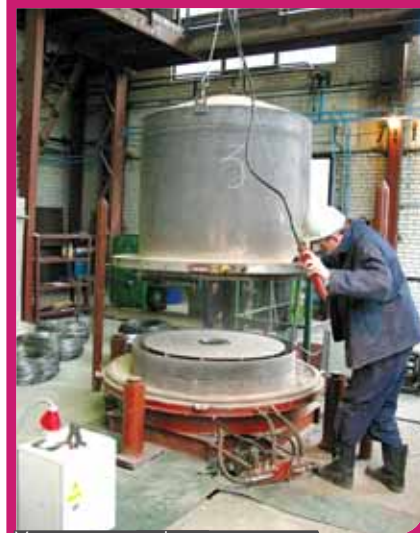
Установка муфеля на стенд
