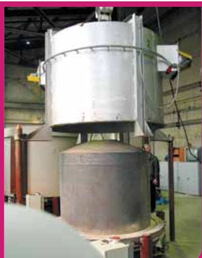
Подъем охлаждающего колпака
