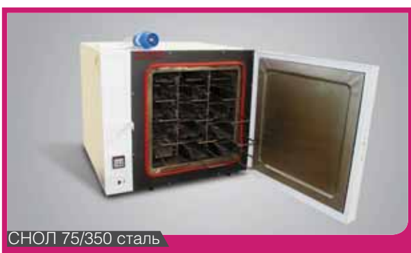
СНОЛ 75/350 нерж. рабочая камера с лотками
