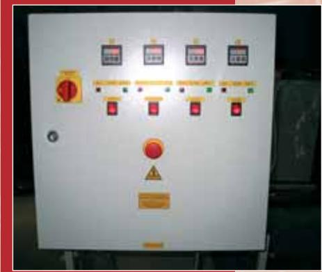
Блок управления плавильной печи
