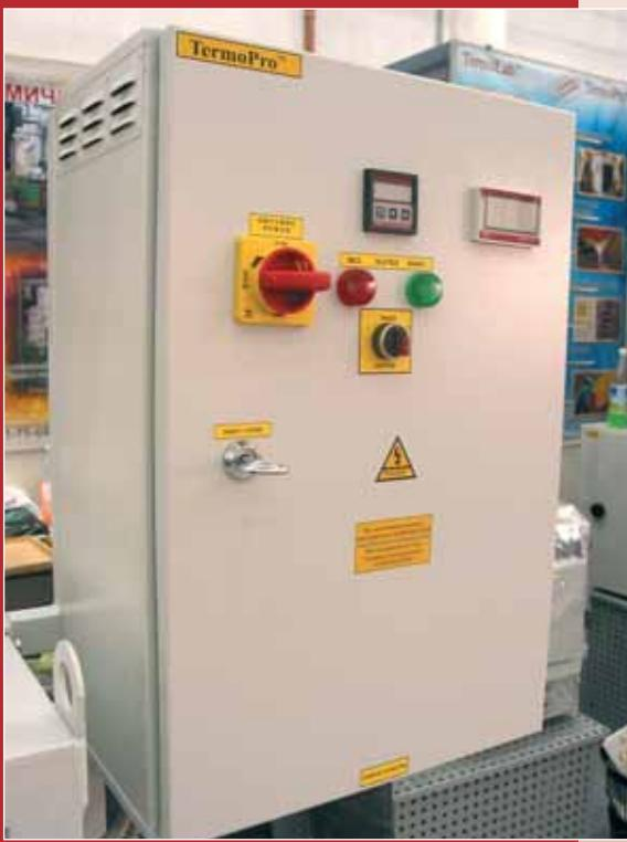
Блок управления к вакуумной печи с самописцем
