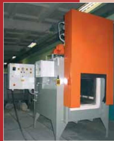
Электропечи предназначены для прокалки сварочных материалов, флюсов, спецэлектродов; высокого отпуска; отжига. Печи изготавливаются со встроенной системой автоматического поддержания температуры в рабочей камере. Предусмотрена система сигнальной индикации за работой печи и визуальный контроль текущей температуры в рабочей камере.
